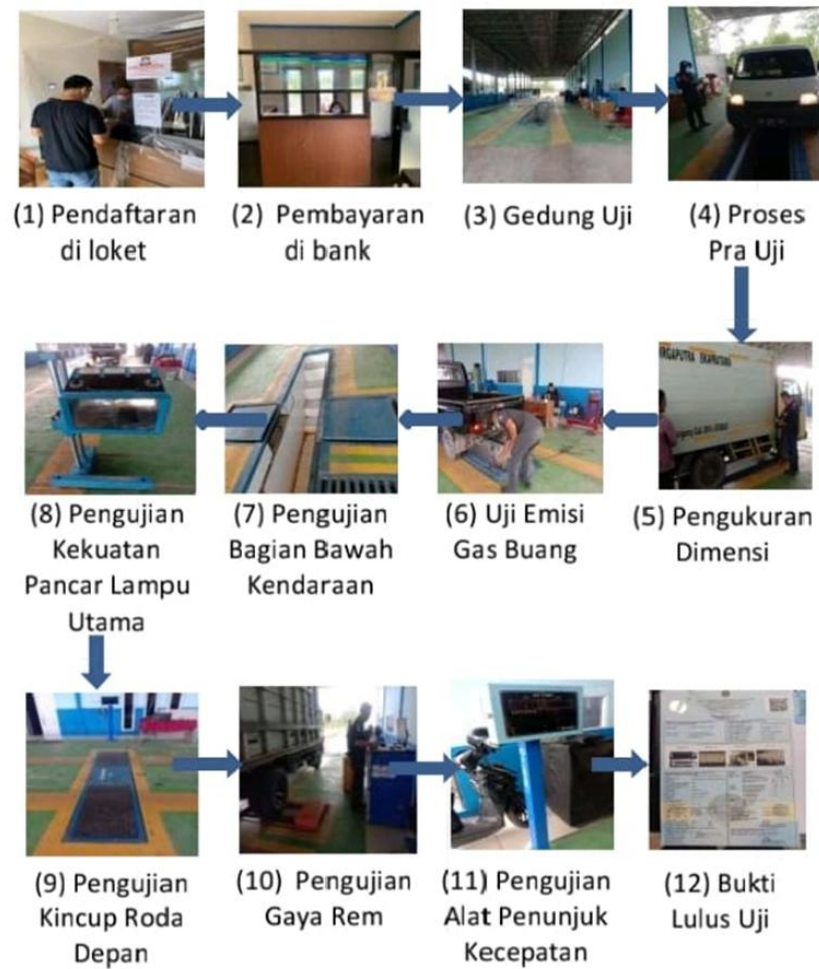
Gambar : urutan pengujian kendaraan bermotor model BLU-e
