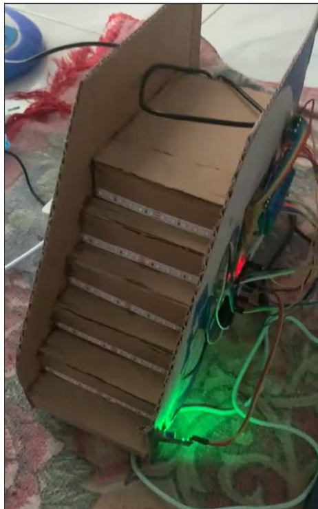
Gambar 11. Hardware Sistem Lampu Otomatis Berbasis Iot Dengan Sensor Gerak Tubuh
