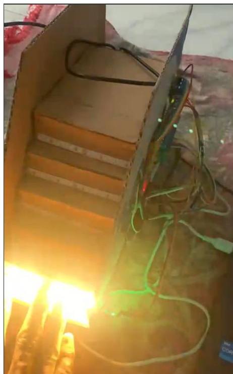
Gambar 12. Lampu menyala saat sensor menangkap gerakan
