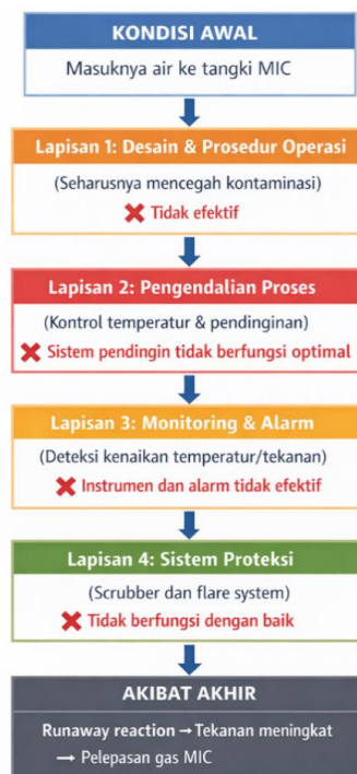
Gambar 6.1 Diagram kegagalan berlapis ( layer of protection failure ) pada kecelakaan Bhopal (1984)
