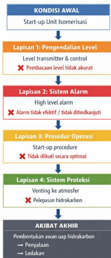
Gambar 6.2 Diagram kegagalan berlapis ( layer of protection failure ) pada kecelakaan kilang Texas City (2005).
