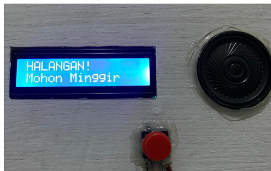
Gambar 10 LCD Menampilkan "HALANGAN" Saat Obstacle Terdeteksi
