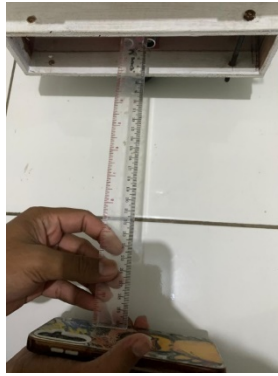
Gambar 9 Pengujian Sensor Ultrasonik dengan Jarak 30cm
