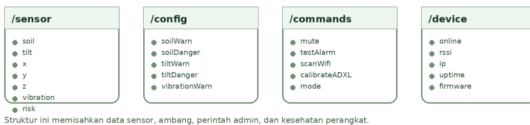
Gambar 6. Struktur data utama pada Firebase Realtime Database
