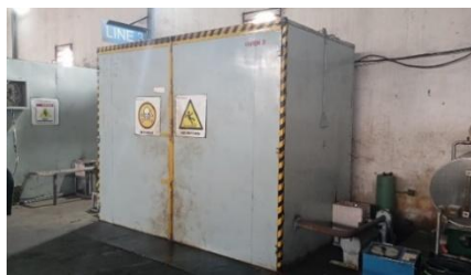
Gambar 2. Tampilan dalam dan luar oven vakum transformator di PT Hariff Power Services
